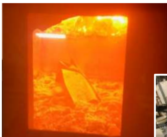
可燃ごみに紛れ焼却炉で 発見された不適物（鉄板）
