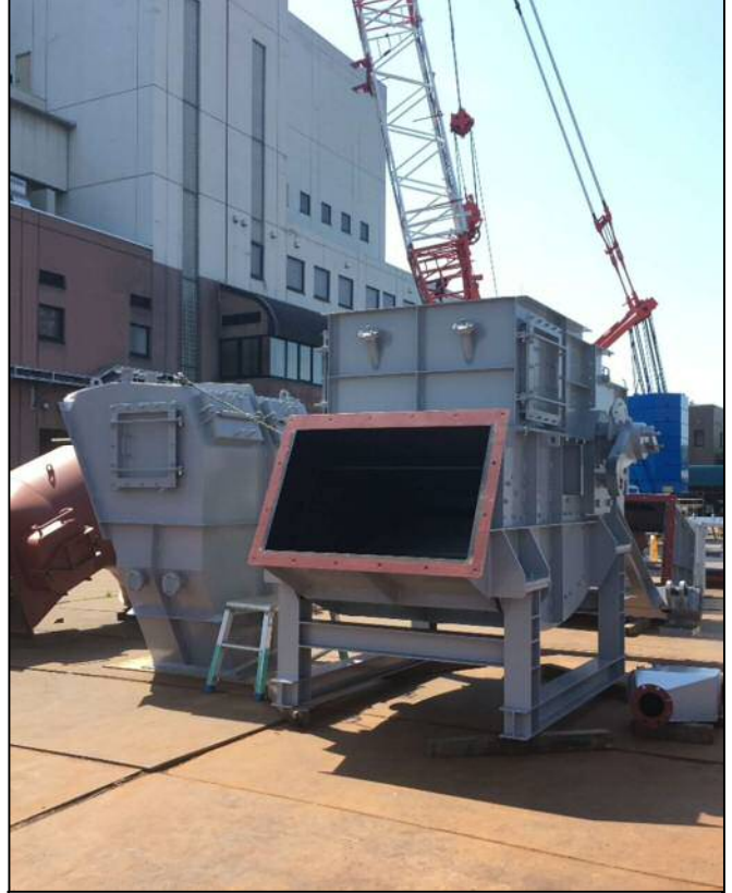
ごみを燃やした灰を運ぶ「灰出装置」
